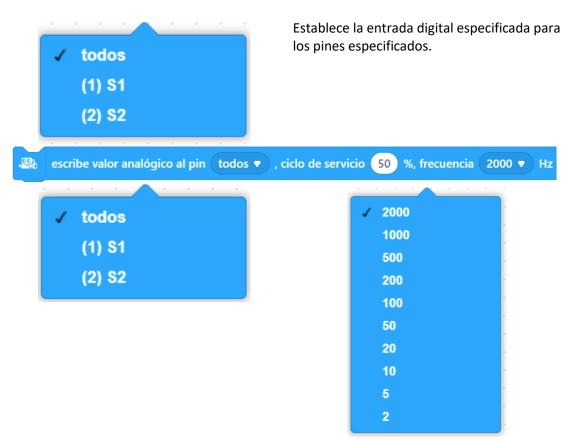
Establece los pines especificados para emitir señales PWM con el ciclo de trabajo y la frecuencia especificados.
