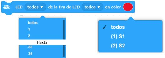
Ilumina los Led especificados en las tiras de LED conectadas a los puertos especificados en el color especificado.
