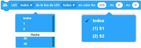
Ilumina los LED especificados en las tiras de LED conectadas a los puertos especificados en el color que es la combinación de la intensidad especificada de rojo, verde y azul.
