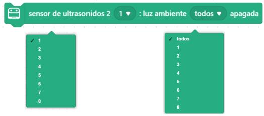
Apaga los LED azules especificados en el sensor ultrasónico 2 especificado.
